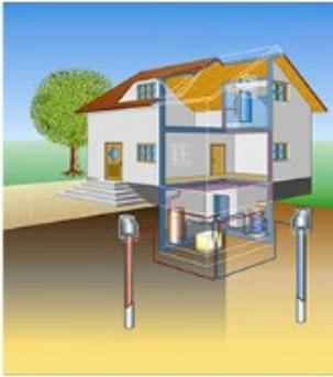
Eine Grundwasser-Wärmepumpe benutzt die im Grundwasser enthaltene Wärme, um damit zu heizen. Da Grundwasser im Jahresverlauf eine konstant hohe Temperatur aufweist, ist es als Wärmequelle hervorragend geeignet. Die Tiefe der Bohrung richtet sich nach der Höhe des Grundwasserspiegels. Aus dem Förderbrunnen wird das Grundwasser nach oben gepumpt und durch Rohre zur Wärmepumpe geleitet. Das abgekühlte Wasser wird dann
