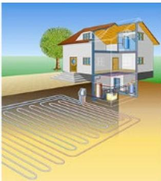
Erdwärmekollektoren sind flache, oberflächennahe Erdwärmennutzungssysteme, die in Tiefen bis 5 m die Erdwärme nutzen. Jahresarbeitszahlen von bis zu 4, welche einen effizienten Betrieb darstellen, sind möglich, die Witterung kann sich im Winter minimal auf die Leistung auswirken. Für diese Technologie ergibt sich ein hoher Flächenbedarf und erhöhte Anschaffungskosten.
