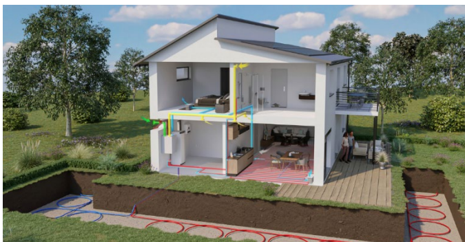
Abbildung 6-15: Schematische Abbildung eines Ringgrabenkollektors (Nibe, 2023).
